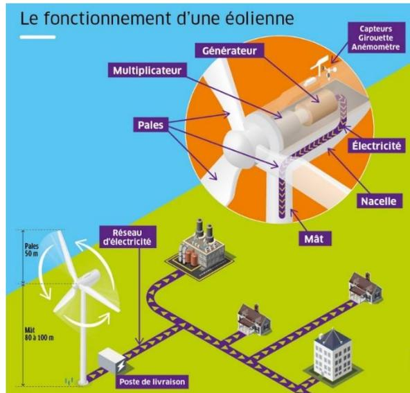
Figure 188 - Principe de fonctionnement et de raccordement d'une éolienne (Source : Engie).
