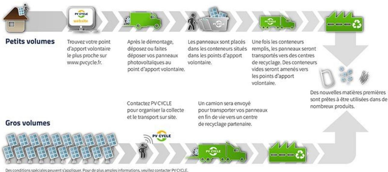
Figure 171 – Fonctionnement de la filière de recyclage des modules photovoltaïques en fin de vie (Source : PV Cycle).
